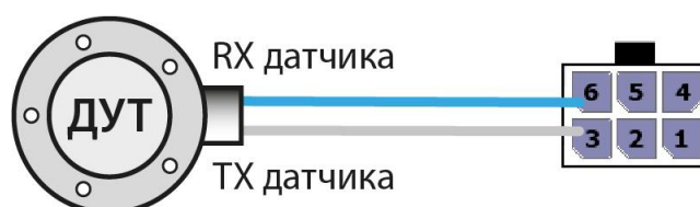
Рис. 53. Схема подключения датчика уровня топлива по интерфейсу RS-232
