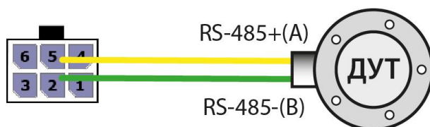
Рис. 54. Схема подключения датчика уровня топлива по интерфейсу RS-485
